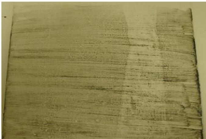
Rimozione di sporco unto ASTM: Detergente EVOGEN per superfici dure esterne RTU diluito 1:10 (100 volte la diluizione del concentrato 10X). A sinistra è mostrato l'aspetto prima della pulizia, quindi dopo un singolo contatto per 15 secondi con il detergente EVOGEN per superfici dure esterne.
